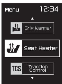
2. Premere l'interruttore "MENU". Verrà visualizzato il display di regolazione del riscaldamento sella e "High" lampeggerà all'interno del display.
