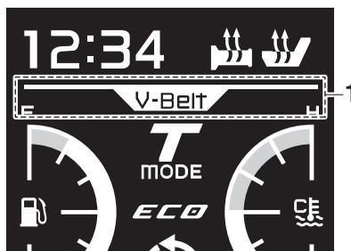
1. Indicatore di sostituzione cinghia trapezoidale “V-Belt”
