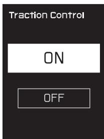
3. Per impostare il sistema di controllo della trazione su "OFF", premere il lato dell'interruttore di selezione "v" per 2 secondi.
