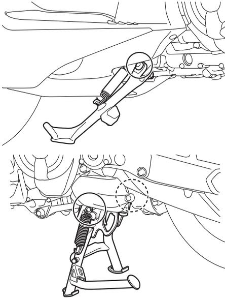
Prima di utilizzare il mezzo, controllare sempre il funzionamento del cavalletto centrale e del cavalletto laterale, e lubrificare, se necessario, i perni di guida e le superfici di contatto metallo/metallo.
