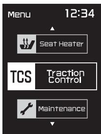
2. Premere l'interruttore "MENU". Sarà visualizzato il display di regolazione del sistema di controllo trazione e "ON" lampeggerà su display.
